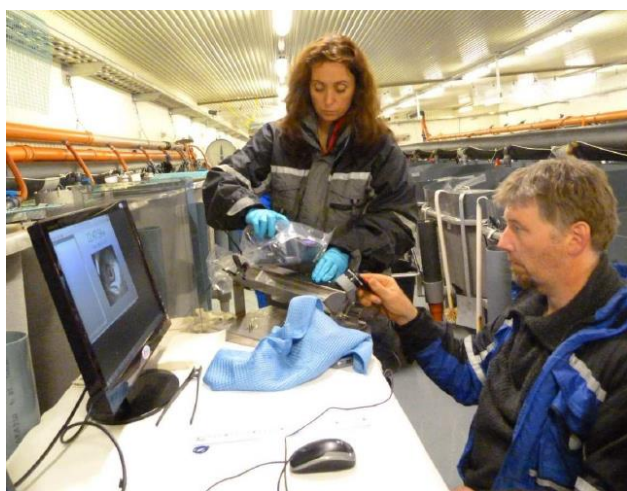
Figur 11 Bilde som viser samtidig lesing av PIT-tag og irisskanning. (Figur: Nofima)
