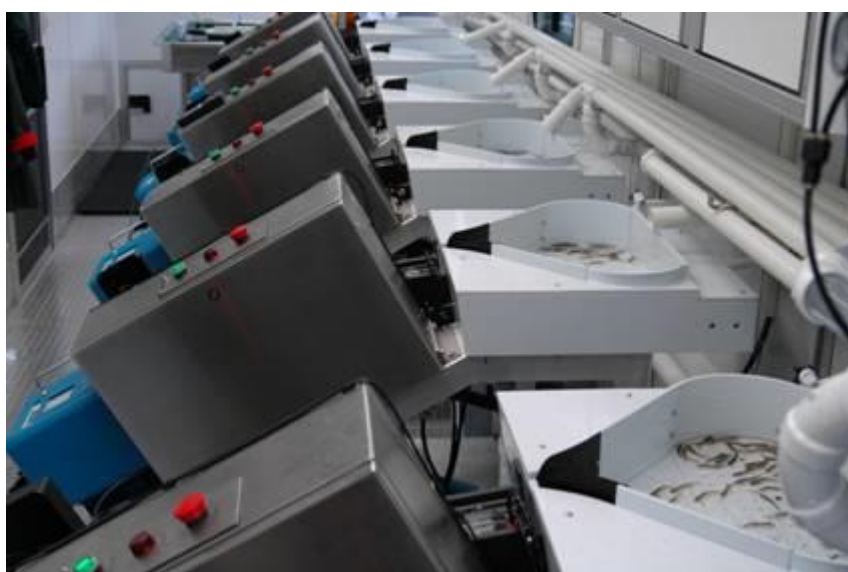
Figur 4 Automatisert fettfinneklipping på små fisk, USA (Foto NMT)
