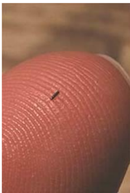
Figur 5 CWT merke 1,1 millimeter langt (Bilde NMT)
